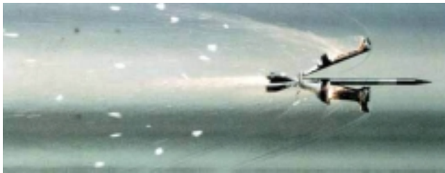
Figur 1: Pfeilmunition kurz nach dem Abschuss, im Moment der Ablösung des Pfeils von seinem Treibspiegel.
